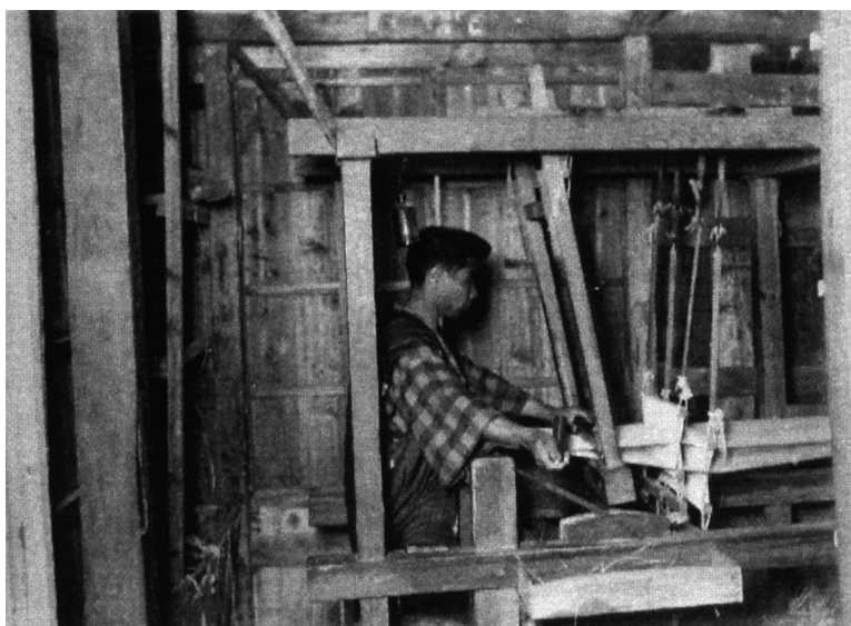
写真5 しめぼた 締機 大島紬の原糸に模様をつける為の機 於阿伝 昭11.4 [目録番号: 写真類1-14-42]
